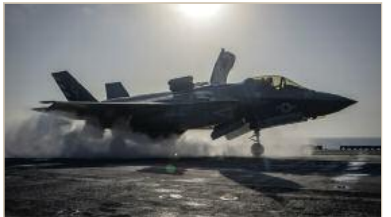
수직 및 단거리 이착륙이 가능한 F-35B 스텔스 전투기
