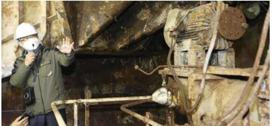
26일(한국시간) 오후 전남 목포시 목포신항에 인양돼 있는 세월호 선체 내부에서 사회적 참사 특별조사위원회 관계자가 고착 상태가 발견된 조타 장치 등을 설명하고 있다.
