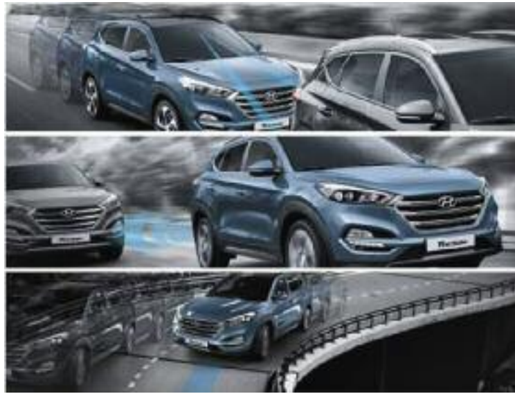
현대자동차 올뉴투싼에 장착된 자동긴급제동시스템(AEB). 앞 차량의 급제동이나 보행자의 이동 등을 감지해 자동으로 차량을 긴급 제동시키는 기능이다
