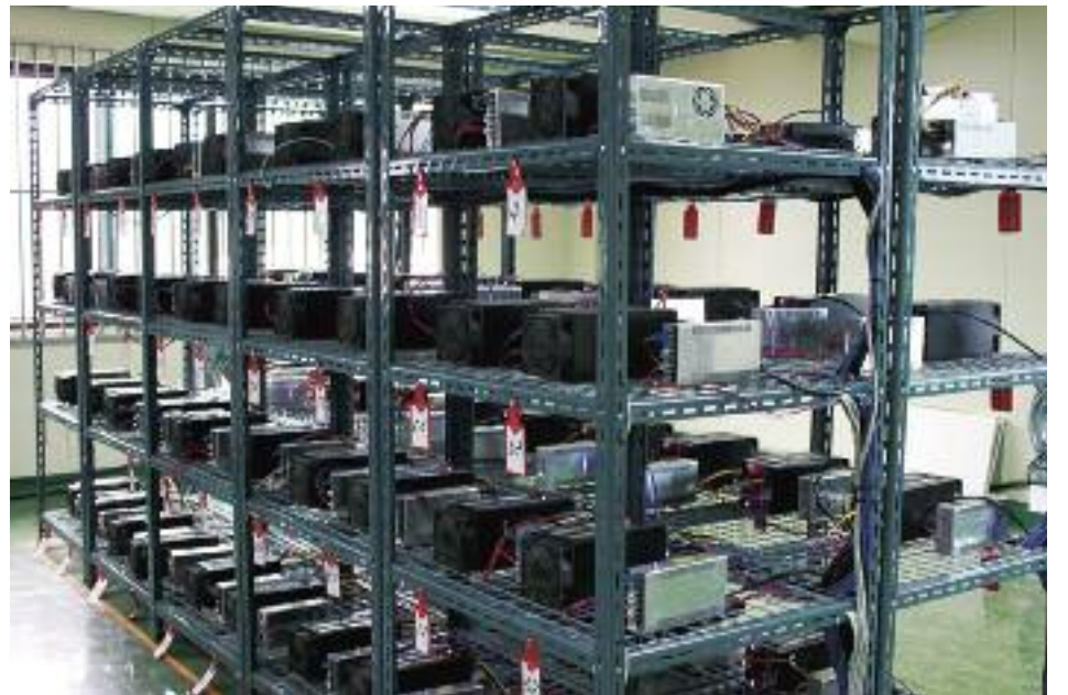
강원 홍천군 (주)SM마이닝 공장. 이가로 31cm, 세로 13cm 크기의 채굴기가 앵글로 만든 선반위에 일정한 간격으로 놓여있는 채굴장의 모습
