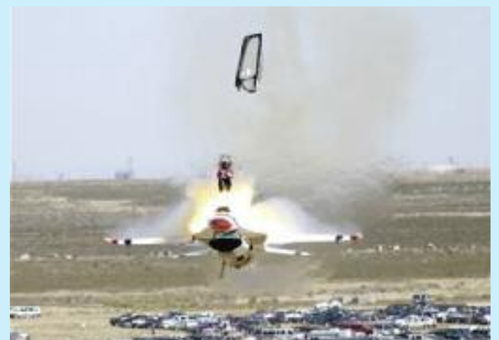
F-16기를 이용한 사출좌석 비상탈출 시험
